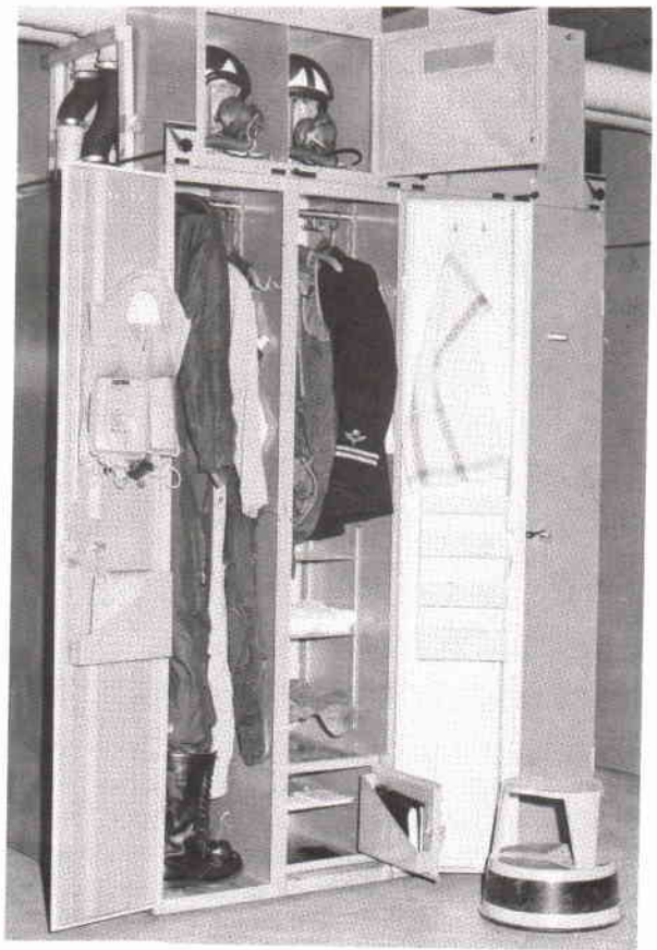
I vänstra skåphalvan finns varmluftslangar som torkar fukten ur isolerdräkten.
