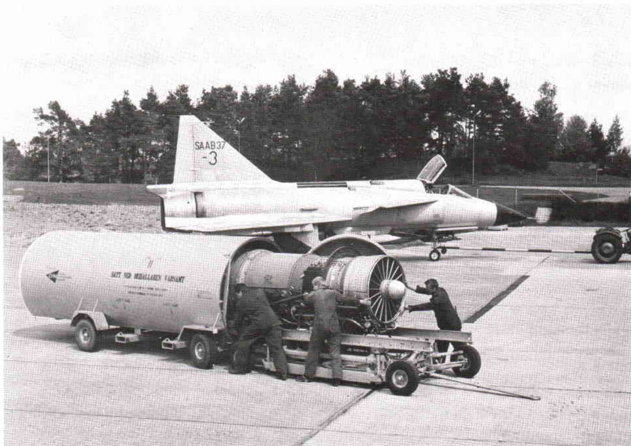
Det går smidigt att skjuta in motorn på plats i behållaren från monteringsvagnen. I bakgrunden AJ37. Bild SAAB.
